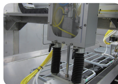
자동건 높이 조절 Auto level adjustment (Spray Gun)
